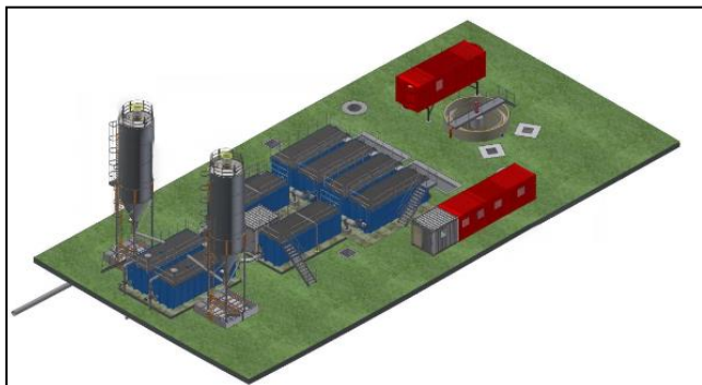
Abbildung 7: Beispiel einer modularen, zwei-straßigen Anlage
